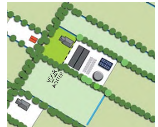
Duurzaamheid: mestvergistingsinstallatie en grondopstelling zonnepanelen op achtererf/ niet zichtbaar vanaf openbare ruimte
