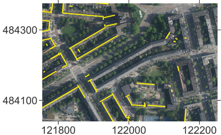
Figuur 15 Een luchtfoto van een noklijn die geleidelijk afbuigt en een noklijn die onder een kleine hoek afbuigt. Beide verschijningen zijn niet uitgewerkt in DakGemak. De noklijnen zijn (indirect) geschat op basis van AHN4 data uit tegel 25GN1. De achtergrondfoto komt van Beeldmateriaal.
