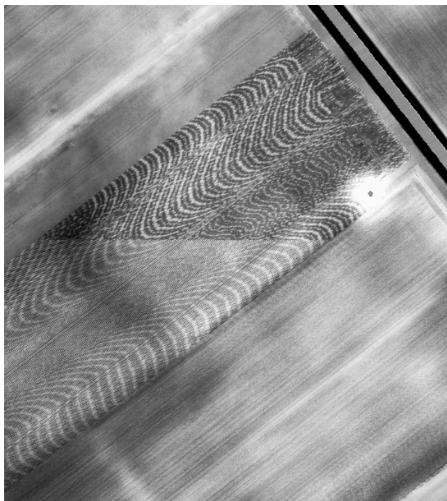
Figuur 11: Ribbels in de hoogtedata als gevolg van landbewerking tussen twee opnamevluchten (Bron: Controlerapport NEO voor AHN2009 Midden, deellevering 2)
