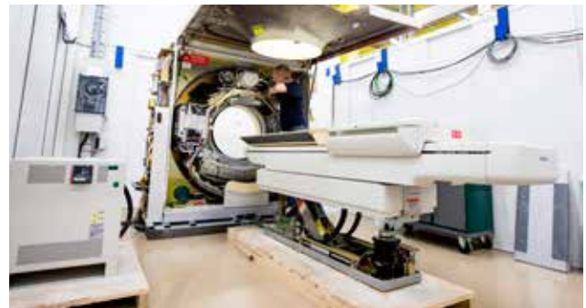
Figuur 7: Een monteur is bezig met de revisie van een medisch systeem in de nieuwe fabriek van Philips Refurbished Systems in Best. Bron: Philips.
