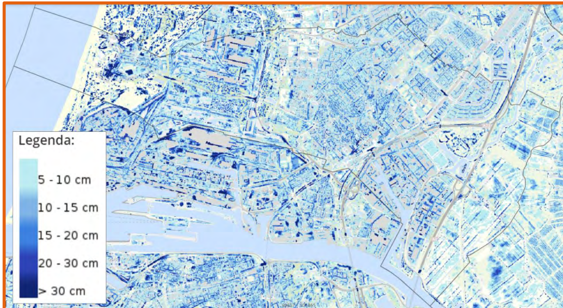
Figuur 5.14 Waterdiepte bij kortdurende hevige neerslag (70 mm/2 uur). Deze buien komen in het huidige klimaat eens per 100 jaar voor. Bron: Deltares, 2016. Nationaal Water Model. Verkregen via Kaartviewer - Klimaat-effectatlas , geraadpleegd in maart 2023
