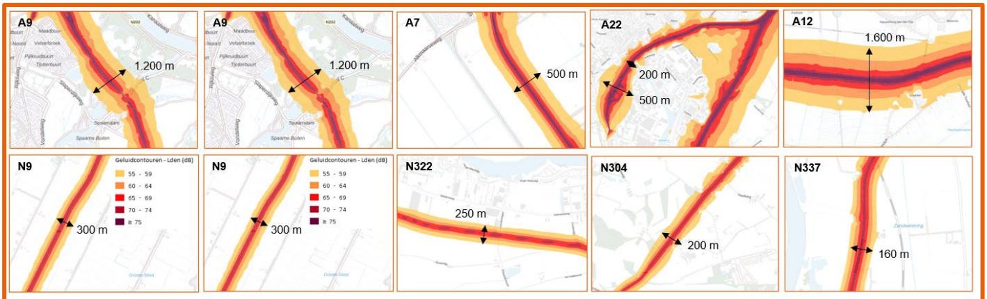
Figuur 6.7 Vergelijking geluidscontouren Rijkswegen met Provinciale wegen (kaart Atlas van de Leefomgeving, Geluid verkeer op hoofdwegen Lden)
