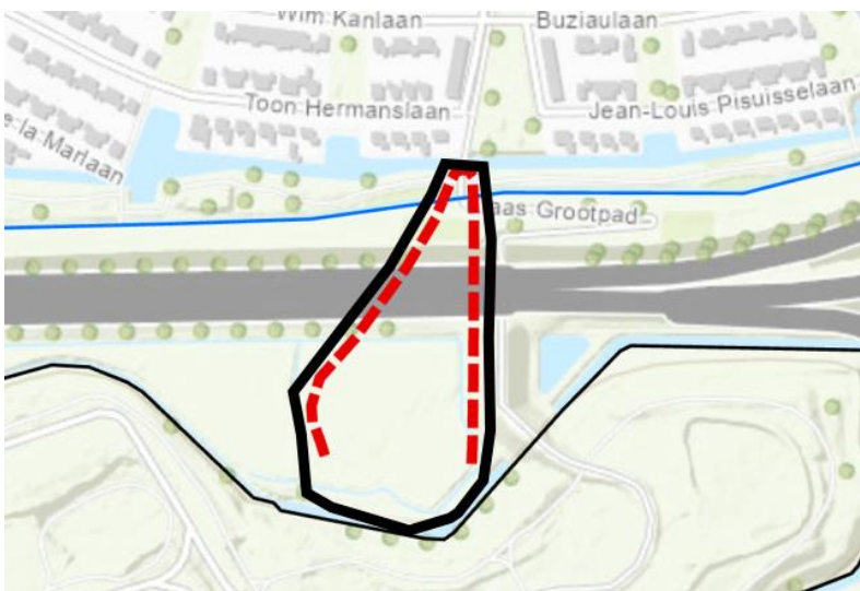
Figuur 1: In het zwart de damwand rond de benzeenverontreiniging
