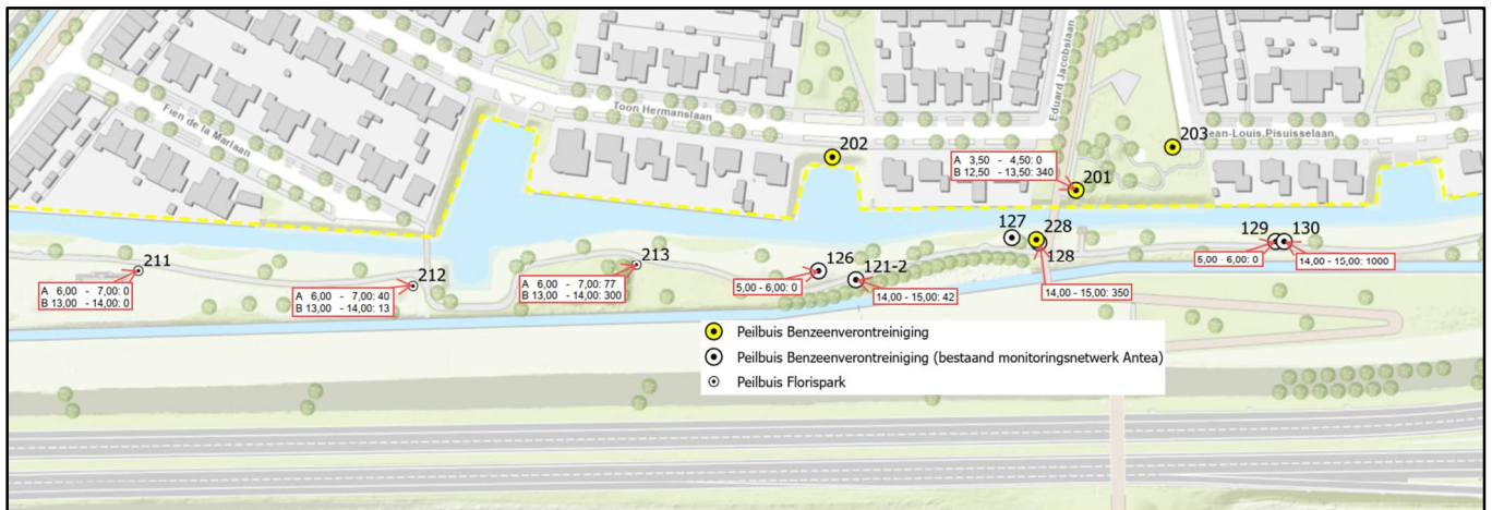
Figuur 6-1: Analysesresultaten cyanide in grondwater met filterstelling en gemeten concentratie in µg/l
