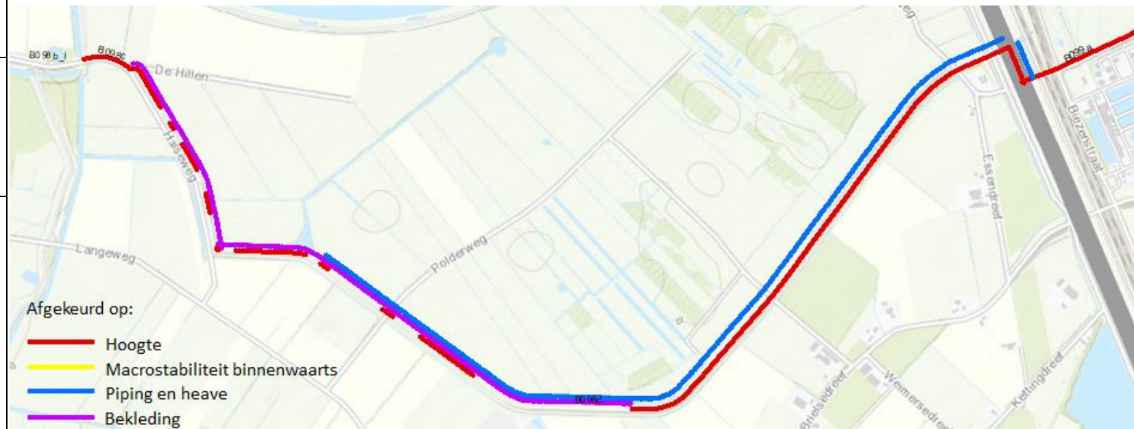
Figuur 3, Faalmechanismen waar de kering op afgekeurd is
