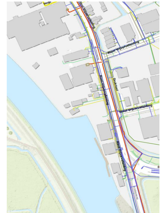
Figuur 5 uitsnede klic-melding met ligging kabels en leidingen
