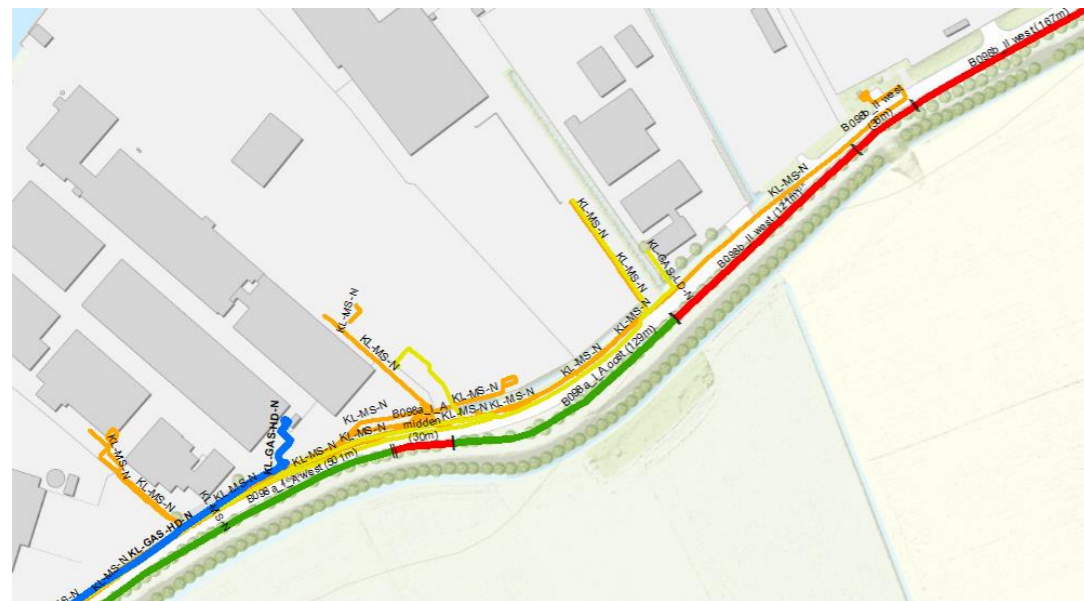
Figuur 2 Bovenaanzicht met kabels en leidingen. In blauw de HD gasleiding, in geel de LD gasleiding en in oranje en middenspanningskabel.
