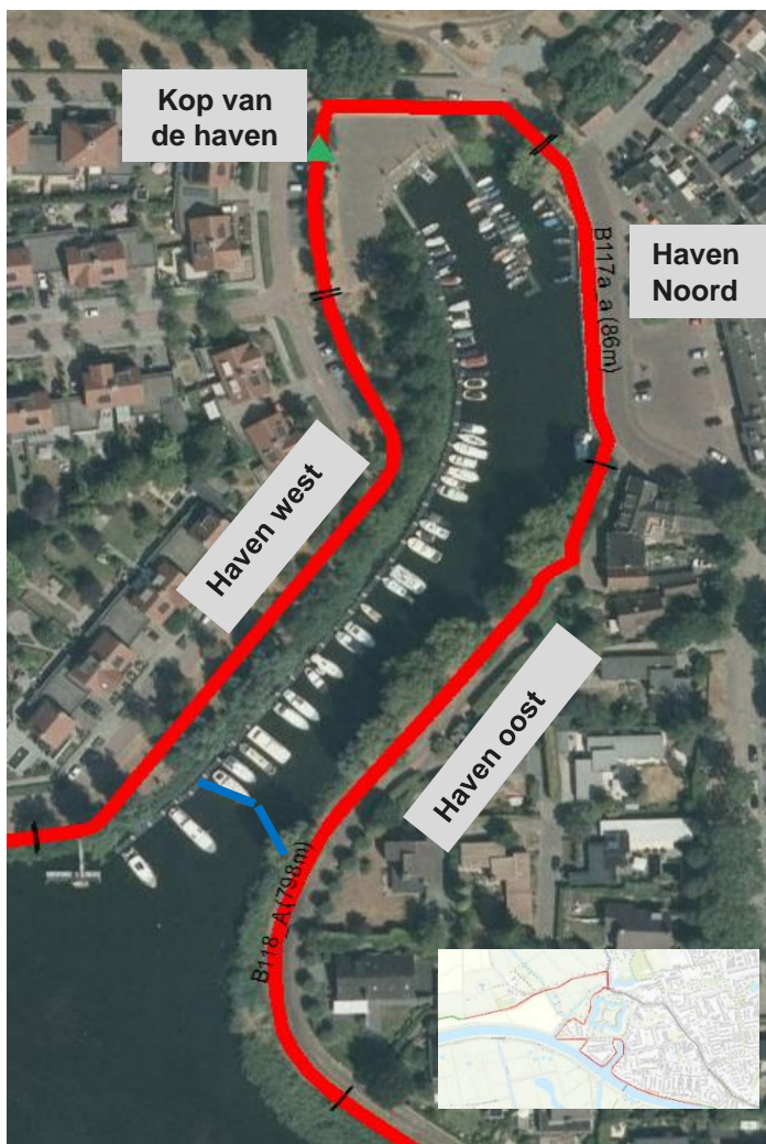
Figuur 17 Boven-aanzicht deelgebied Haven met in rood de afgekeurde kering
