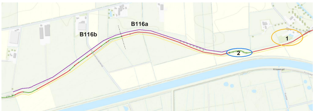
Figuur 40 Overzicht van het deelgebied. In rood/groen is de huidige keringlijn weergegeven. De rode stukken zijn de afgekeurde strekkingen en de groene stukken de goedgekeurde strekkingen. De maatwerklocatie Laakdijk 1 is oranje omcirkeld. De goedgekeurde strekking met waardevolle bomen is blauw omcirkeld
