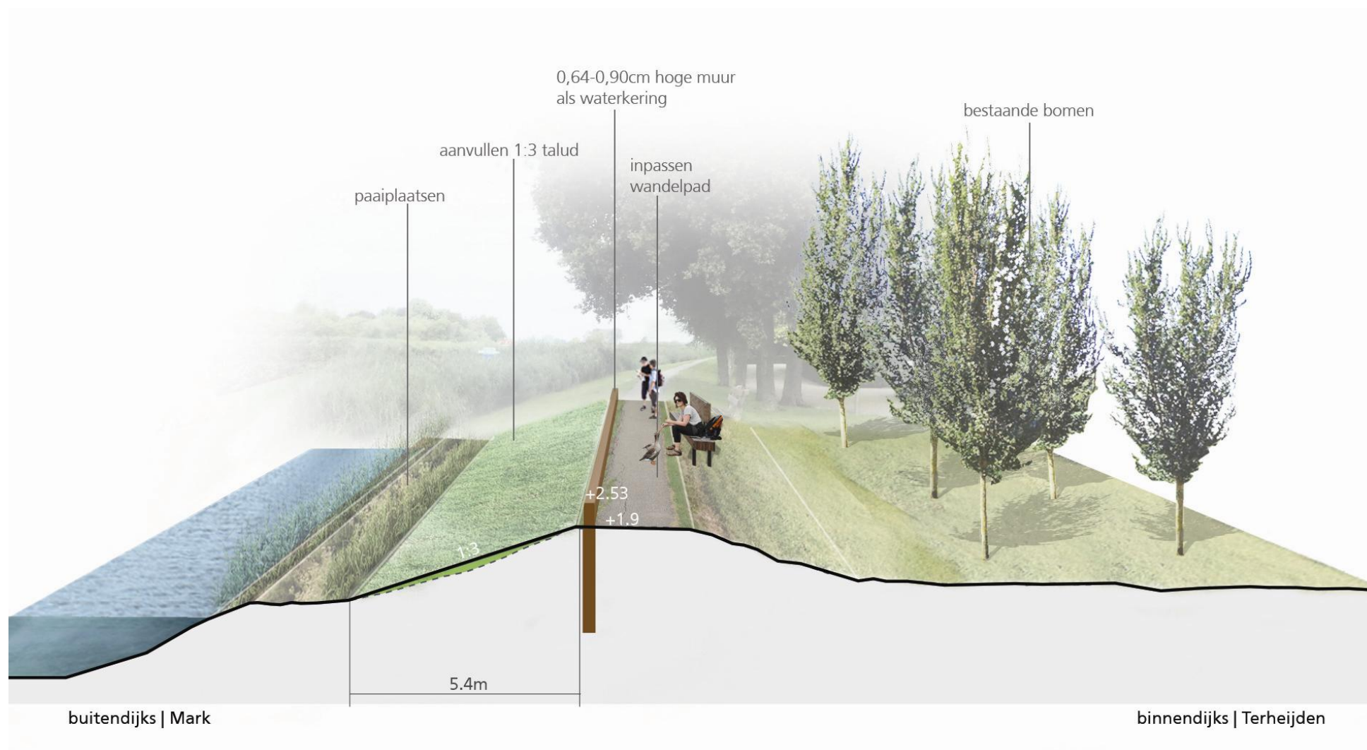
Figuur S-5 3D visualisatie voorkeursalternatief in deelgebied Terheijden- Markkant strekking 1 en 2 (nieuwe situatie op de voorgrond, oude situatie op de achtergrond).
