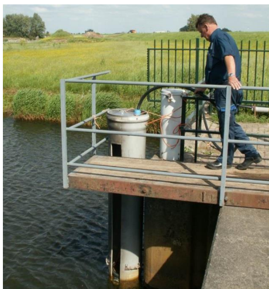
Figuur 6.1. Tijdelijke vangstconstructie bij gemaal Keizersveer in de voorjaren van de periode 2011-2017.
