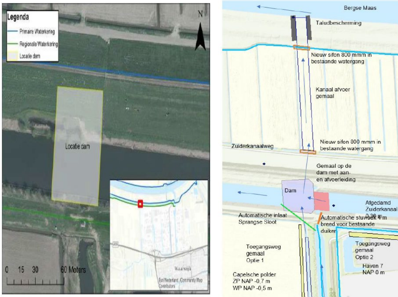
Figuur 5. Locatie van de aan te leggen dam in het Zuiderkanaal (links) en schets van de waterhuishoudkundige wijzigingen (rechts) (uit: Jurrjens, 2019).
