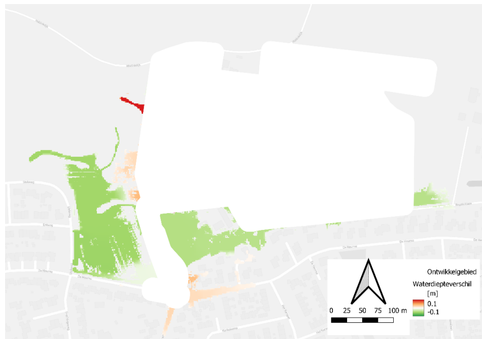
Figuur 5-3 Waterdiepteverschil maatregelvariant 1 ten opzichte van bestaande situatie. Rood geeft aan waar de maximale waterdiepte toeneemt, groen geeft aan waar de maximale waterdiepte afneemt.
