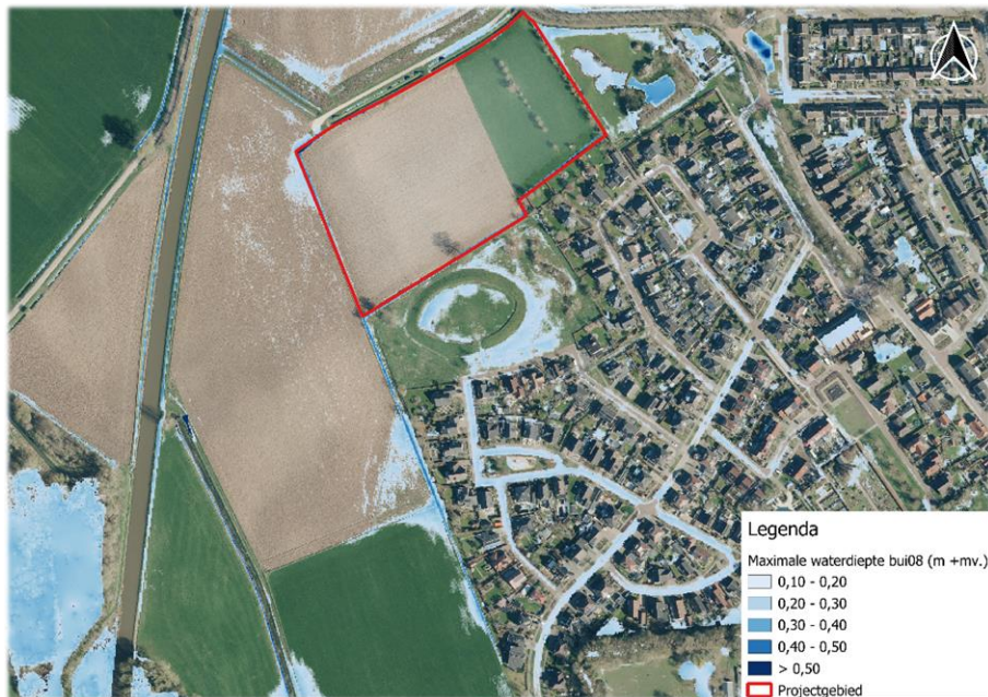
Figuur 22. Maximale waterdiepte bui08 bouwplan
