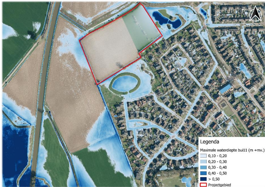
Figuur 25. Maximale waterdiepte bui11 bouwplan
