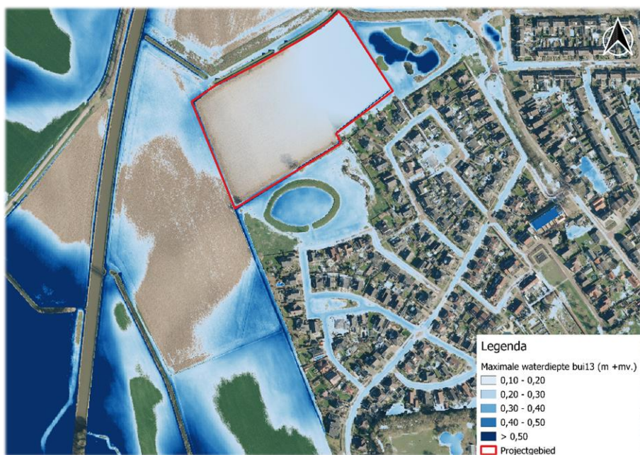
Figuur 28. Maximale waterdiepte bui13 bouwplan
