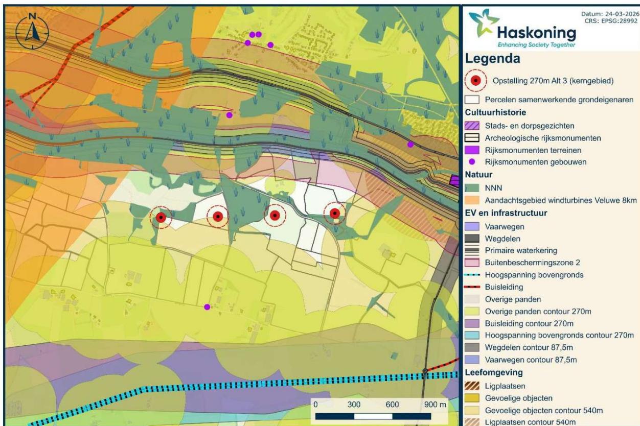
Figuur 5-15 Alternatief 3 – lijnvariant met 2.5x rotordiameter onderlinge afstand en betere ruimtelijke inpassing. Alleen windturbines westelijke kerngebied. Er passen 4 windturbines.
