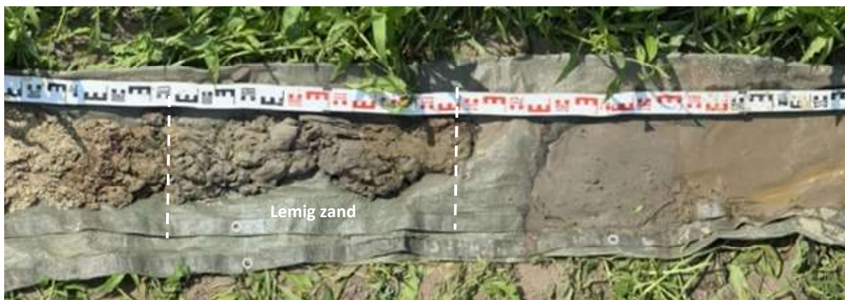
Foto 1: bodemboring B5 met leemlaag in het dekzand
