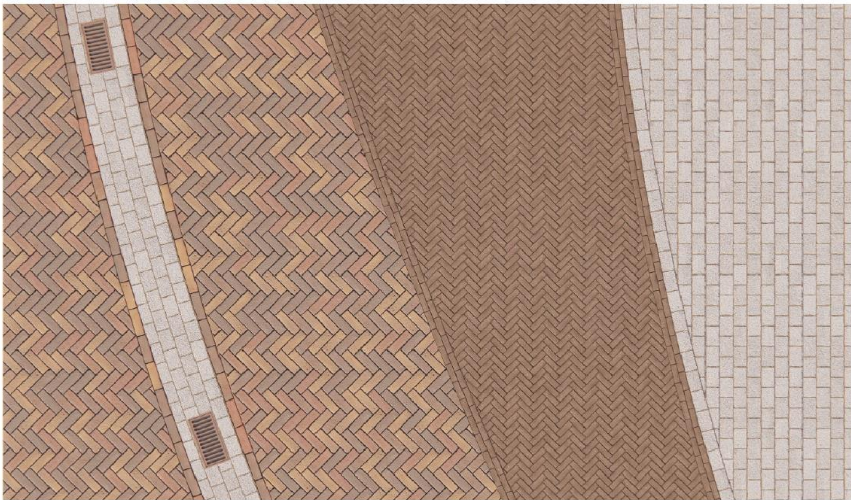
Afbeelding 8: detail van het bestratingspatroon. De huidige goot wordt vervangen door een geklinkerde goot met straatkolken.
