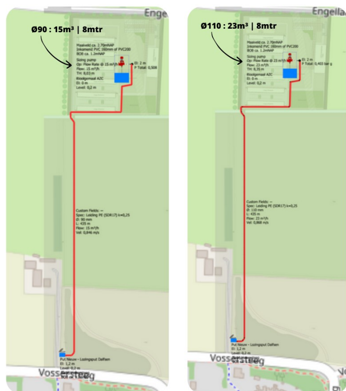
Pompput en Persleiding (hydraulisch model) Ø90 en Ø110
