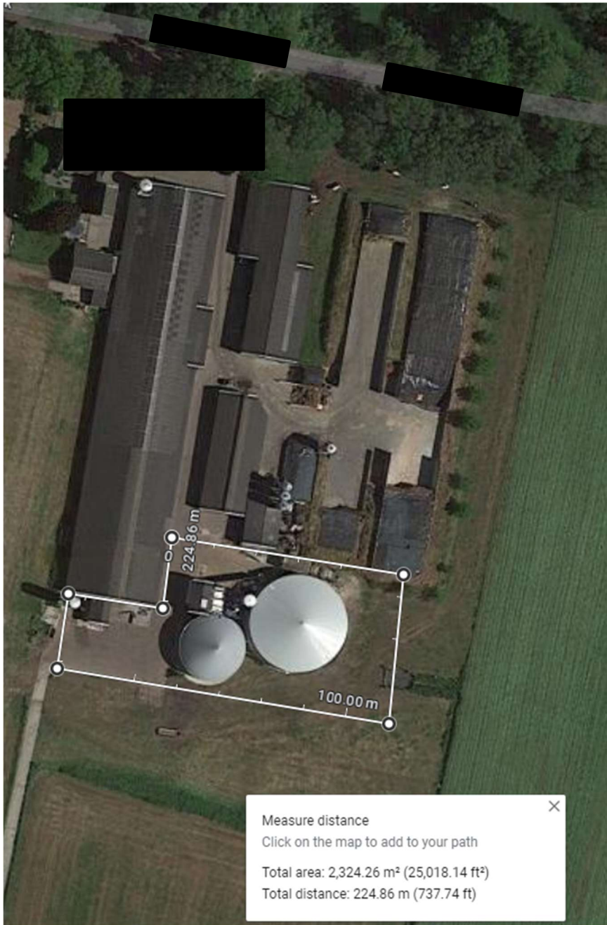
Figuur 9: voorbeeld van een melkveehouder met een vergister + stikstofstripper en WKK voor de vergisting van eigen mest. Het ruimtegebruik is ongeveer 0,25 hectare
