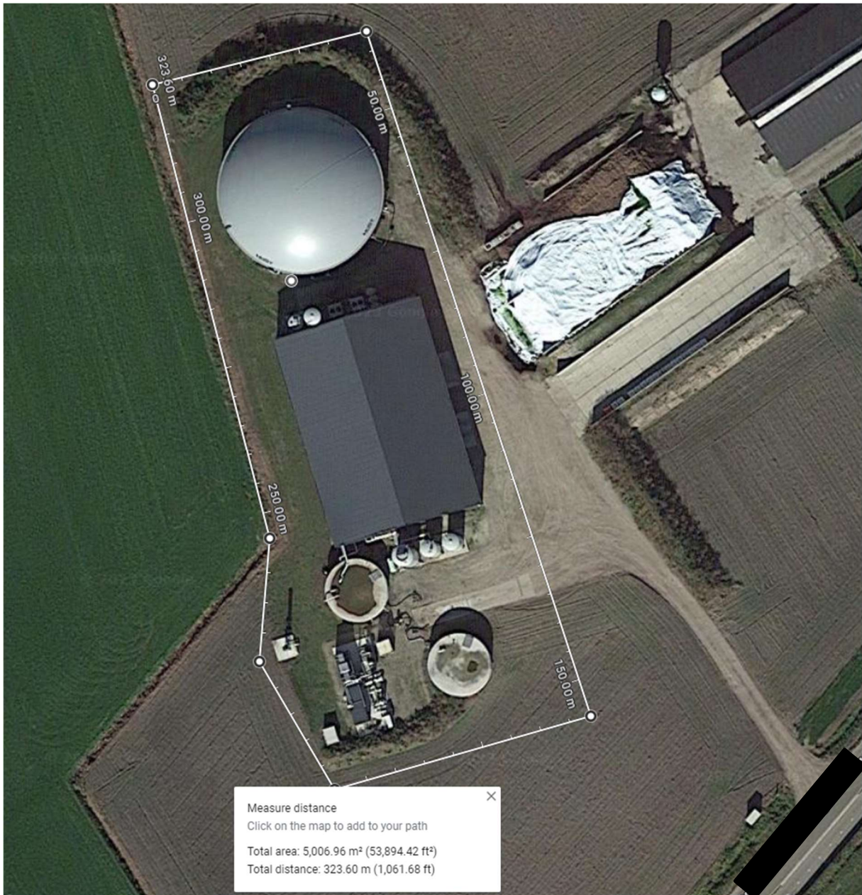
Figuur 8: voorbeeld van het grondgebruik van een collectieve vergistingsinstallatie (ca. 15-20 melkveehouders) + stikstofstripper en groen gas opwerking en invoeder. Hier wordt de mest vergist en 1,1 miljoen m 3 groen gas ingevoerd op het net. Het ruimtegebruik is ongeveer 0,5 hectare
