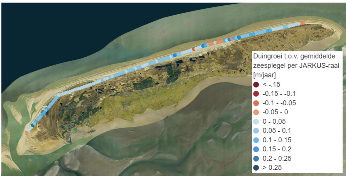
Figuur 21 Blokkendoos Levendige Kust – Duingroei 1990-2021 zonder zeespiegelstijging per Jarkus-raai. Duingroei per raai is gedefinieerd (per strekkende meter) als een gemiddelde groei boven de 3m +NAP.
