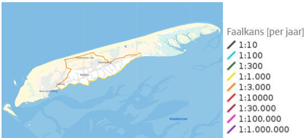
Figuur 10 Normen voor primaire waterkeringen. De kleuren geven de maximaal toelaatbare overstromingskans (ondergrens) aan, zoals deze is gedefinieerd in de Waterwet (afbeelding uit https://waterveiligheidsportaal.nl/ ).
