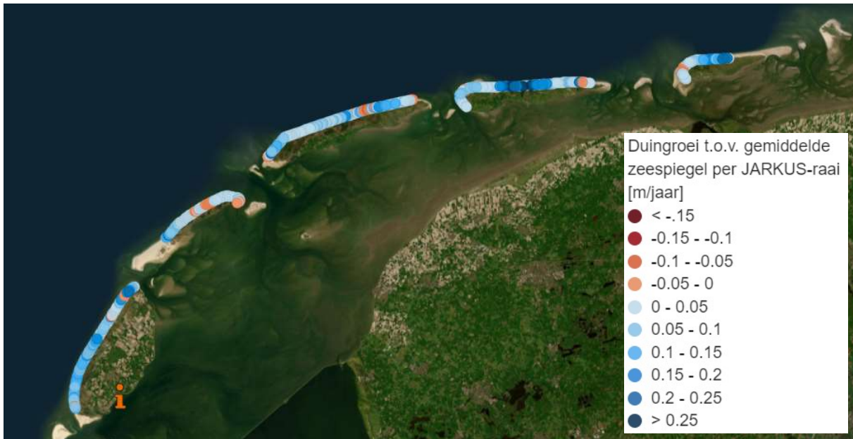
Figuur 9 Aanzanding van de duinen op de Waddeneilanden in de periode 1990-2021. Weergegeven is of het dwarsprofiel zoveel meegroeit dat het een zeespiegelstijging van 50 cm tot 2100 op kan vangen (zoals eerder is onderzocht in Wegman et al., 2021 8 , https://dmmangrove.hkvservices.nl/blokkendoos-levende-kust/ ).
