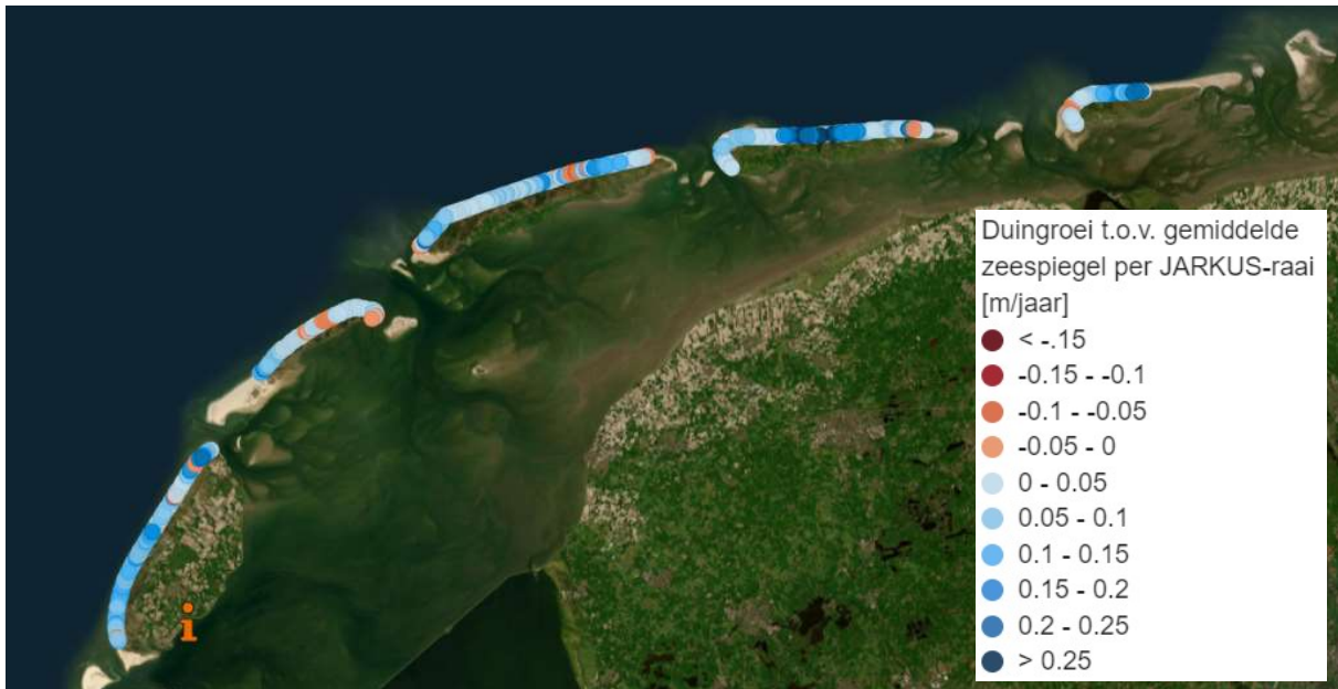
Figuur 9 Aanzanding van de duinen op de Waddeneilanden in de periode 1990-2021. Weergegeven is of het dwarsprofiel zoveel meegroeit dat het een zeespiegelstijging van 50 cm tot 2100 op kan vangen (zoals eerder is onderzocht in Wegman et al., 2021 9 , https://dmmangrove.hkvservices.nl/blokkendoos-levende-kust/ ).
