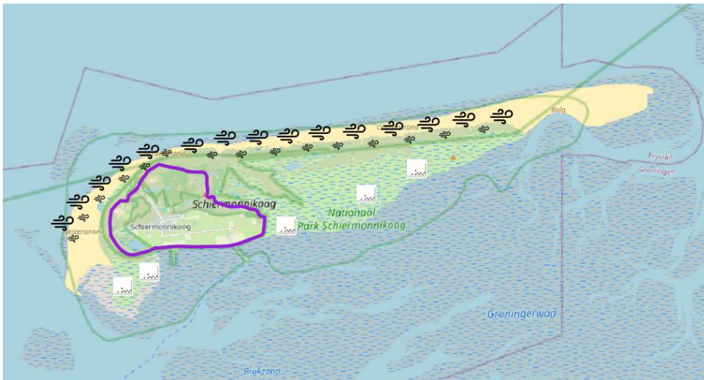
Figuur 23 Locaties waar doorstuiving (windvaantjes) en waar meegroeien van voorlanden ( ) gestimuleerd kan worden binnen ambitieniveau 3. In paars de primaire kering.
