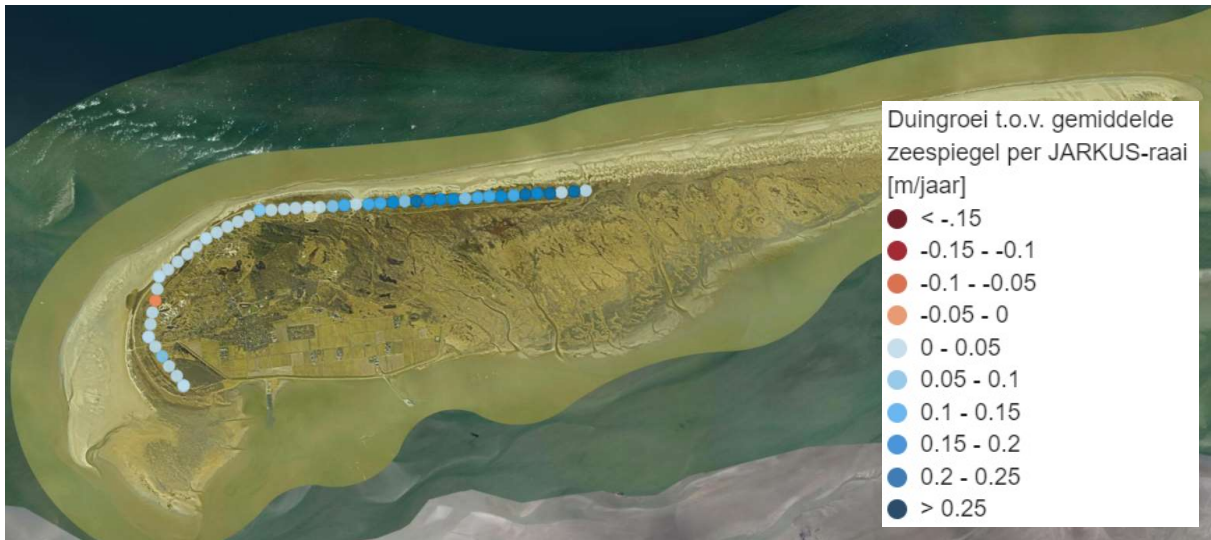
Figuur 20 Blokkendoos Levendige Kust – Duingroei 1990-2021 zonder zeespiegelstijging per Jarkus-raai. Duingroei per raai is gedefinieerd (per strekkende meter) als een gemiddelde groei boven de 3m +NAP.
