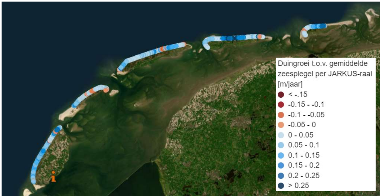
Figuur 8 Aanzanding van de duinen op de Waddeneilanden in de periode 1990-2021. Weergegeven is of het dwarsprofiel zoveel meegroeit dat het een zeespiegelstijging van 50 cm tot 2100 op kan vangen (zoals eerder is onderzocht in Wegman et al., 2021 7 , https://dmmangrove.hkvservices.nl/blokkendoos-levende-kust/ ).
