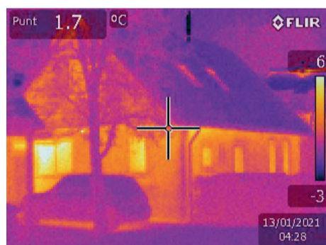
Dit is een voorbeeld van een warmtefoto. De warmste delen worden met lichte kleuren (wit en geel) aangegeven en de donkere kleuren geven koude delen in het huis aan.
