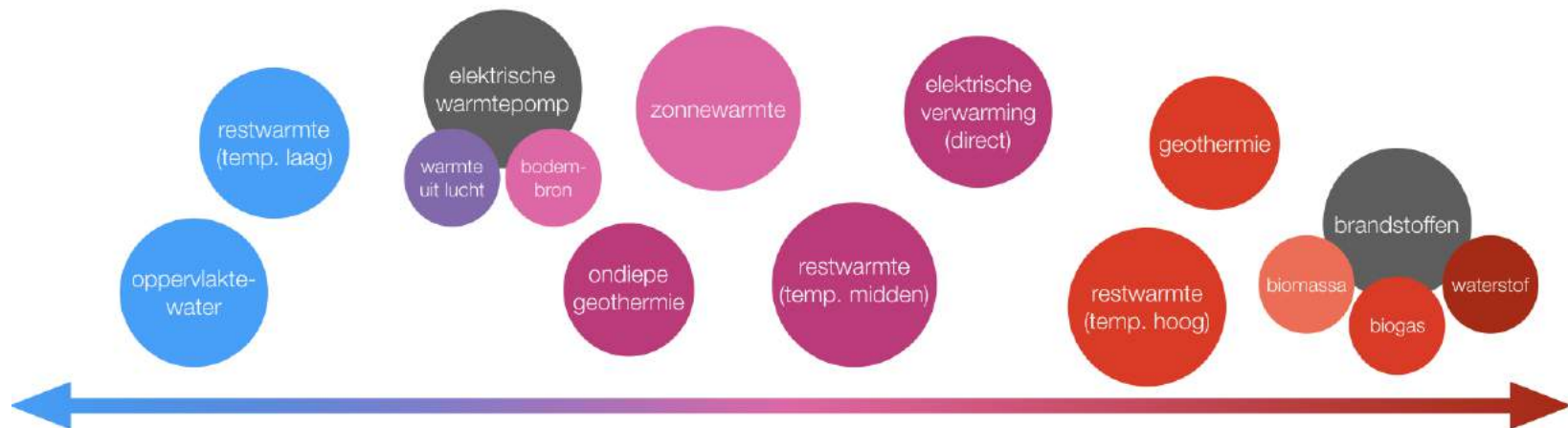
Figuur 5.1 Temperatuurniveau van diverse warmtebronnen van LT (links) naar HT (rechts)
