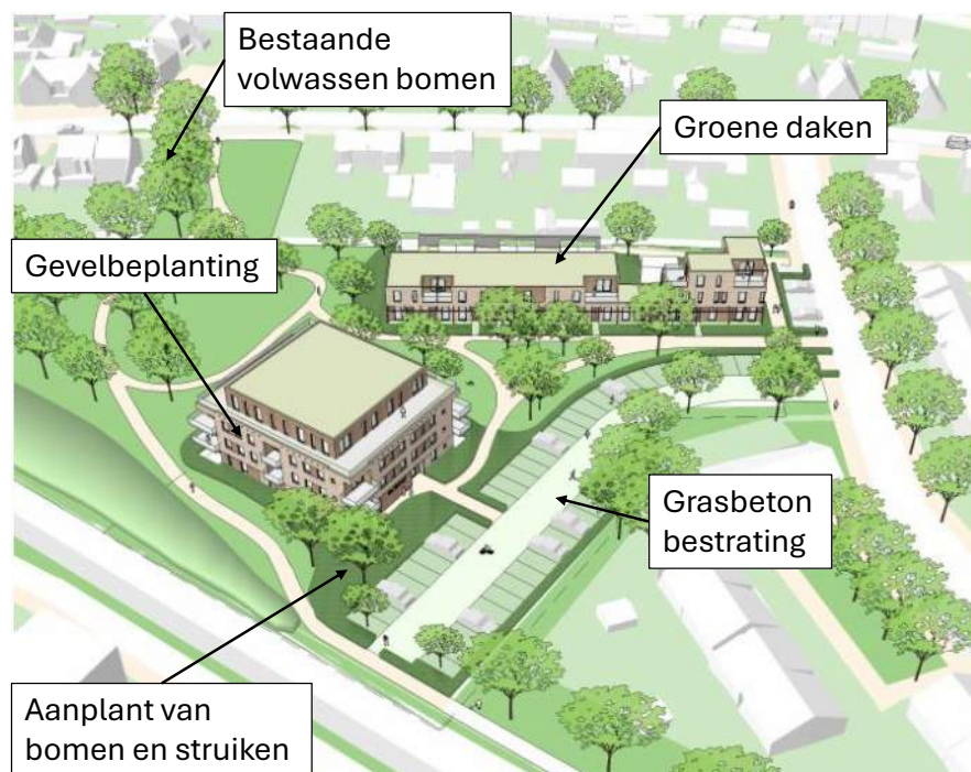
Figuur 4-5: Hittestress maatregelen binnen het plan
