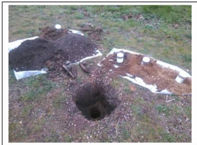
Foto 3. Opgegraven en gezeefd materiaal inspectiegat B03
