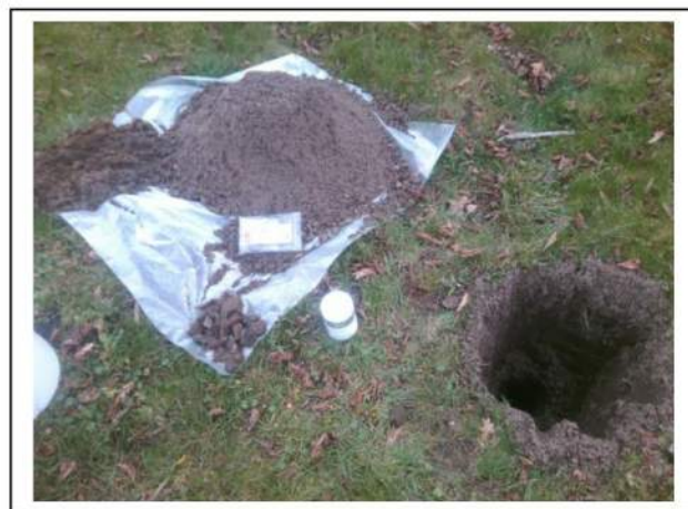
Foto 12. Opgegraven en gezeefd materiaal inspectiegat C09
