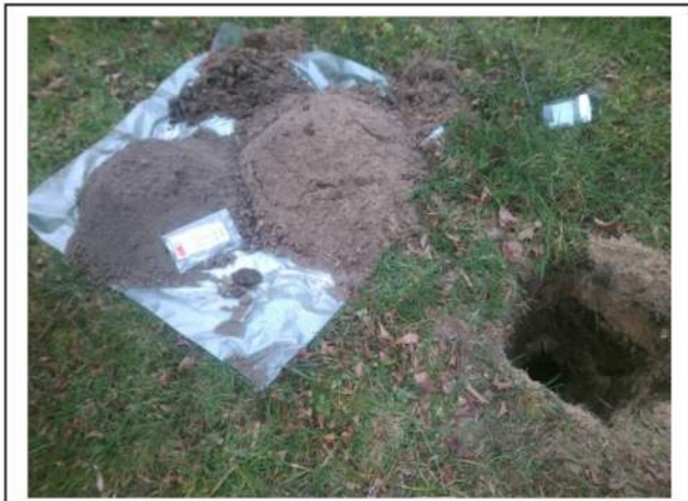
Foto 7. Opgegraven en gezeefd materiaal inspectiegat C03
