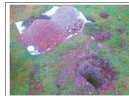
Foto 4. Opgegraven en gezeefd materiaal inspectiegat B04
