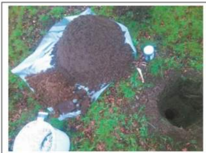
Foto 8. Opgegraven en gezeefd materiaal inspectiegat C04
