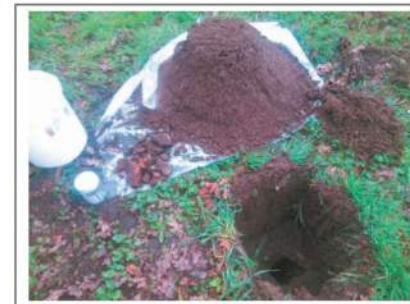
Foto 14. Opgegraven en gezeefd materiaal inspectiegat C11
