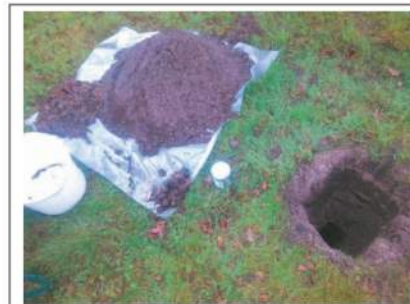
Foto 13. Opgegraven en gezeefd materiaal inspectiegat C10
