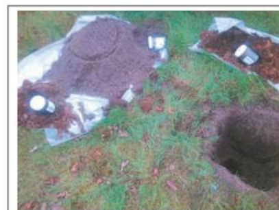
Foto 5. Opgegraven en gezeefd materiaal inspectiegat C01
