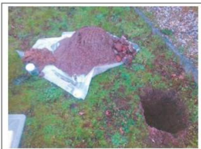
Foto 10. Opgegraven en gezeefd materiaal inspectiegat C06
