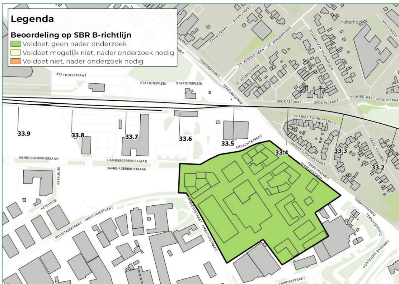
Figuur 5 Beoordeling van de trillingen aan de SBR B-richtlijn, bij fundering op staal
