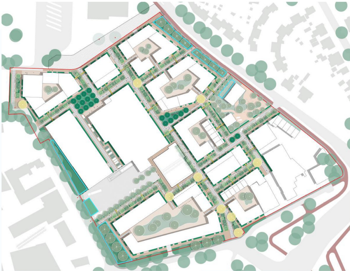
Afbeelding 2: schetsontwerp 15 april 2025 met de raingarden structuren, de groene binnenterreinen, en in het blauw de mogelijke locaties van de wadi's, zoals aangehouden in de berekening
