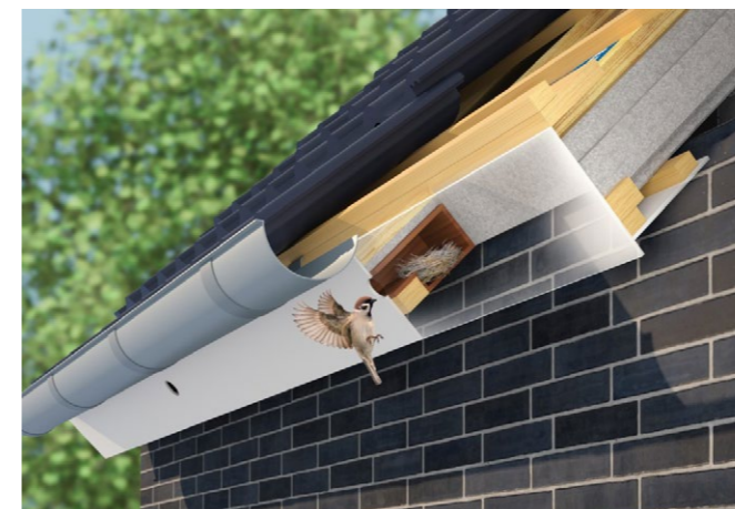
nestkasten in dakconstructie
