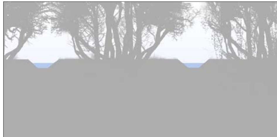
Schematische weergave van een rabattenbos waarbij de sloten parallel lopen en daartussen hogere, drogere gronden met bomen/boschages.
