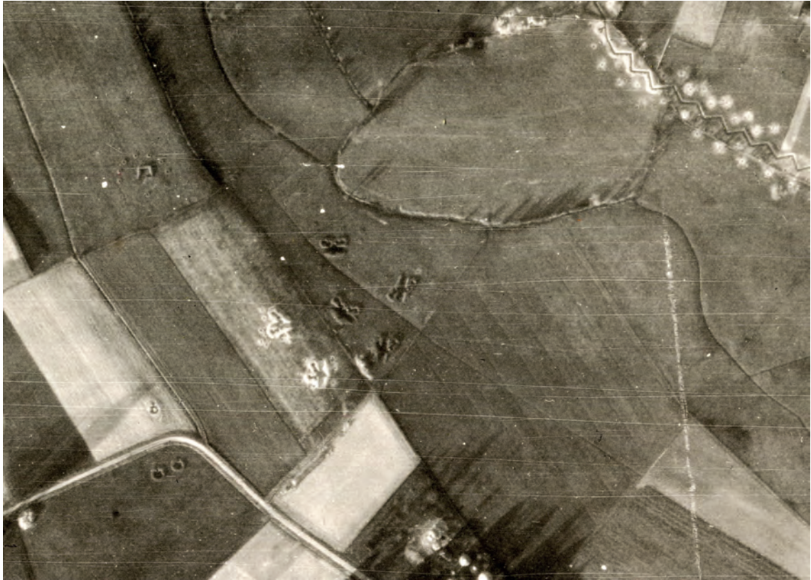
Figuur 20. Kenmerkende verschijningsvorm voor een grote Flak-opstelling bij de kruising A18 met de N317. In het midden zes opstelplaatsen voor geschut in een cirkel en opstellingen voor de vermoedelijke vuurleiding iets ten noordwesten daarvan. Aan de zuidzijde langs de lichtgekleurde akker een strook die vermoedelijk diende als de munitieopslag. Bovenin rechts nog een stukje van de loopgraven rond Doetinchem met schuttersputten aan weerszijden (foto 328-13-3262).
