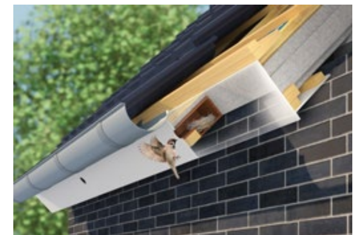
nestkasten in dakconstructie
