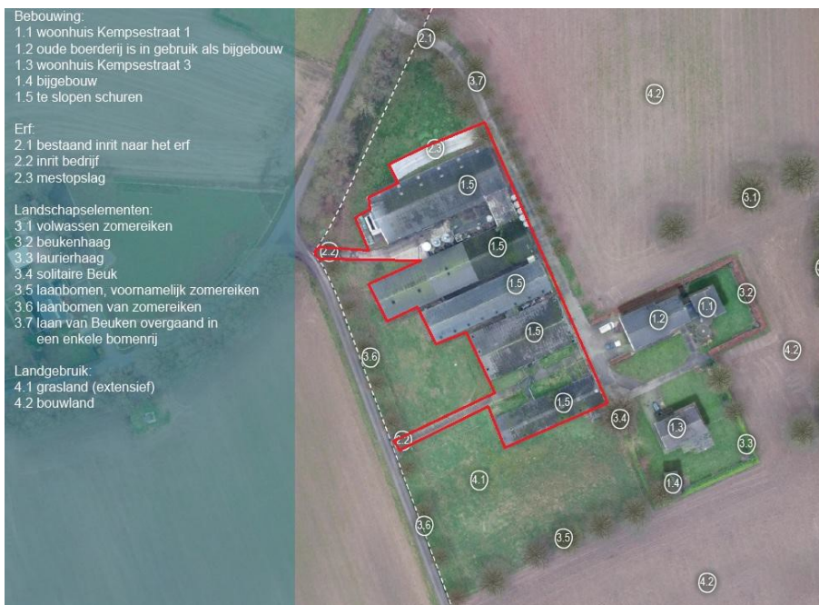
Overzicht te verwijderen bestrating en bebouwing (rode contour)
