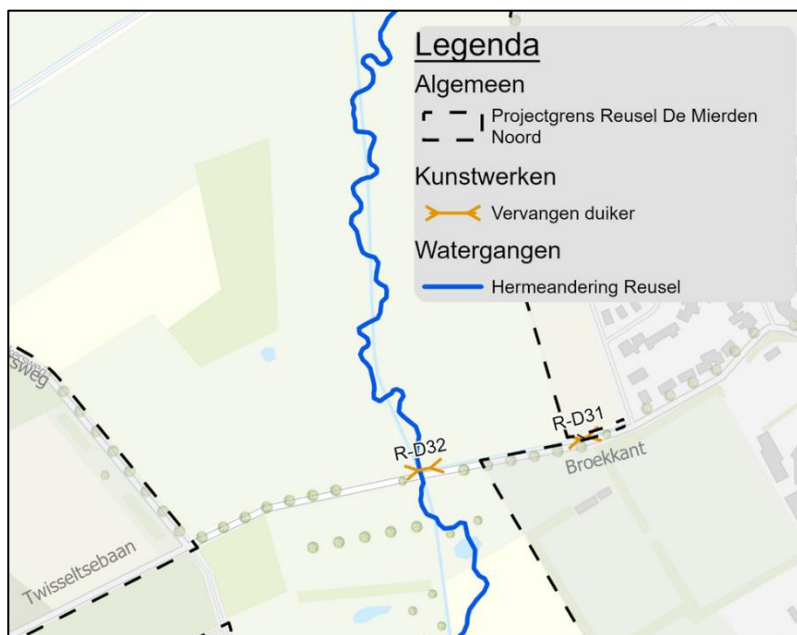
Figuur 1.5-19: Overzicht te vervangen duikers
