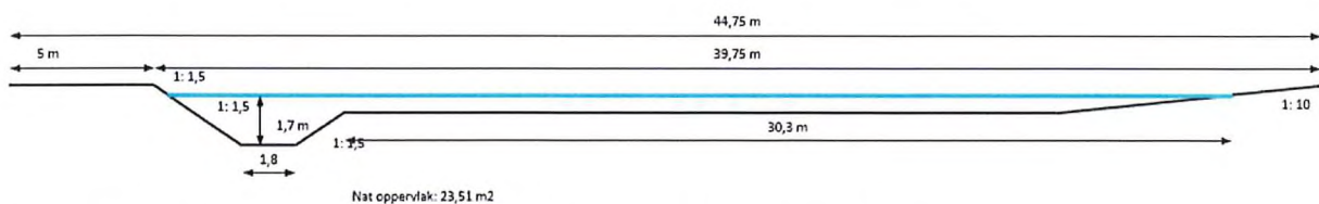
Figuur 5-8: Globaal dwarsprofiel met vlakke zone voor 2 e fase, weergegeven waterlijn is T100
