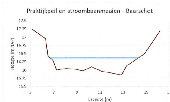
Figuur 5-3: Dwarsprofiel en zomerwaterpeil bij praktijkpeilen en stroombaanmaaien op dezelfde locatie
