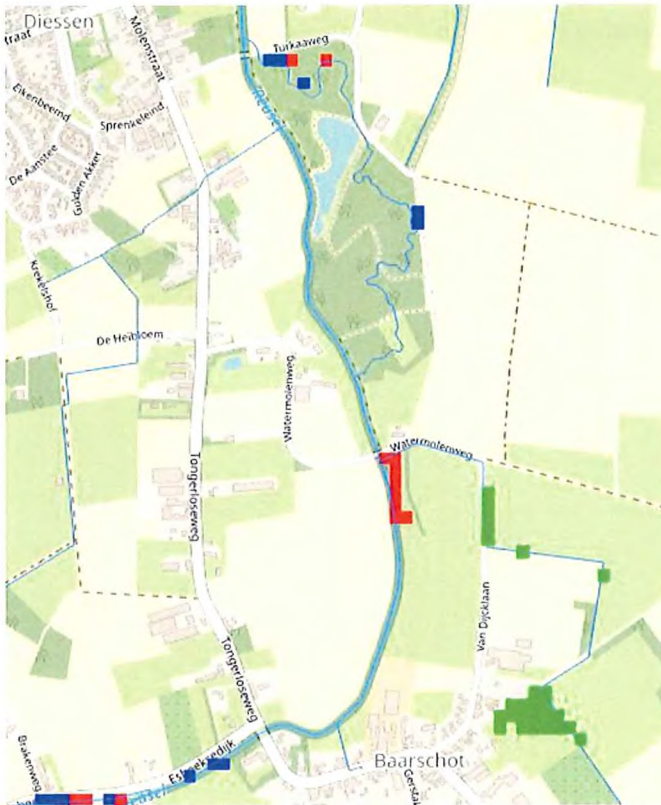
Figuur 25 Inundatie beeld aanpassing duikers RS306, blauw inundatie zowel in referentie als scenario, rood inundatie alleen in scenario, groen inundatie alleen in referentie
