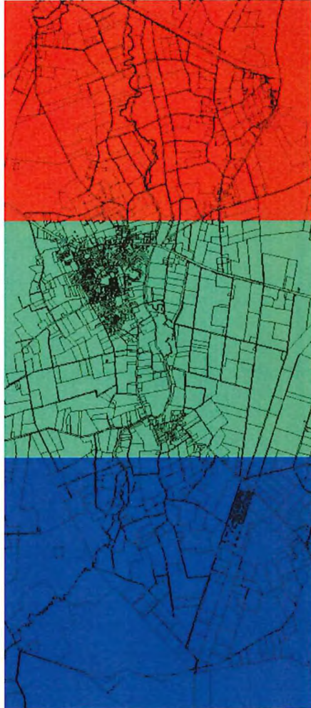
Figuur 3-9 De k-waarden die zijn aangehouden voor het watervoerende pakket, blauw: k-waarde = 25 m/dag, groen: k-waarde 37,5 m/dag en rood k-waarde = 50 m/dag
