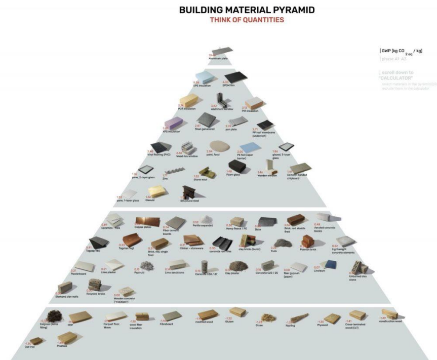
Afbeelding 6.1: een weergave van bouwmaterialen op basis van hun impact op de CO 2 -emissie ( https://www.materialepyramiden.dk/ )
