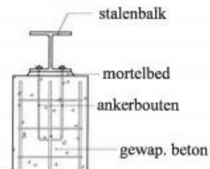
DETAIL OPLEGGING EN VERANKERING STALEN BALKEN
