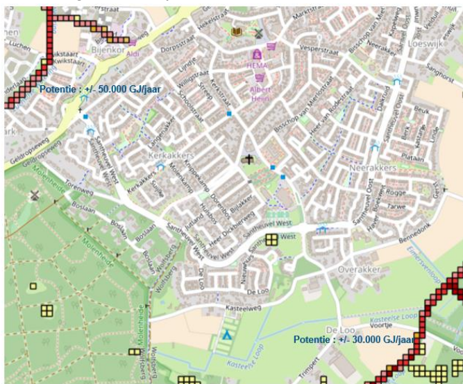
Afbeelding 22 – Potentie WKO Kerkakkers (hoe roder des te hoger potentie, maximale potentie staat in de afbeelding benoemd)
