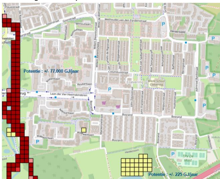
Afbeelding 21 – Potentie TEO Coevering (hoe roder des te hoger potentie, maximale potentie staat in de afbeelding benoemd)
