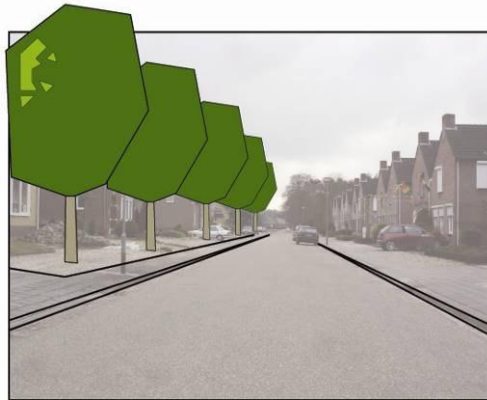
grote beeldbepalende bomen aan één zijde van de straat, waarbij de andere kant van de straat ruimte biedt aan verlichting
