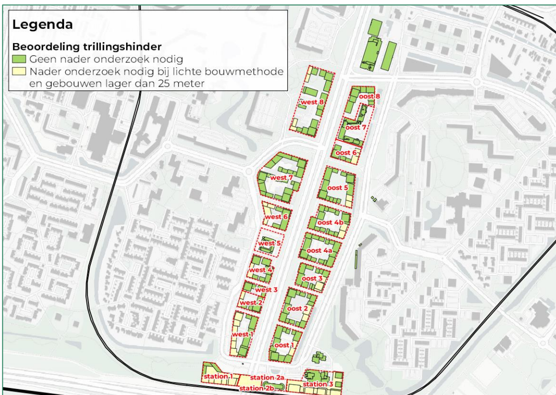
Figuur 15 Locaties waar nader onderzoek nodig is bij gebouwen met een woonfunctie
