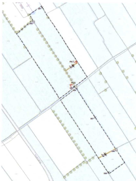
Figuur 5.6 Overzicht verdachte deellocaties en locaties proefboringen en inspectiegaten, deellocatie E
