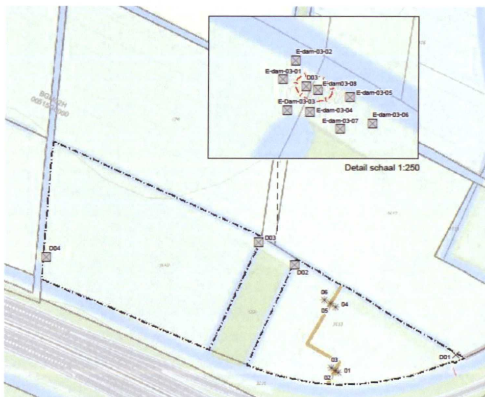
Figuur 5.5 Overzicht verdachte deellocaties en locaties proefboringen en inspectiegaten, deellocatie E
