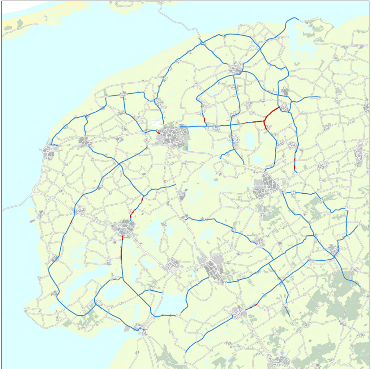
Figuur 4.4: Stil asfalt op wegen met 3 miljoen of meer voertuigpassages
