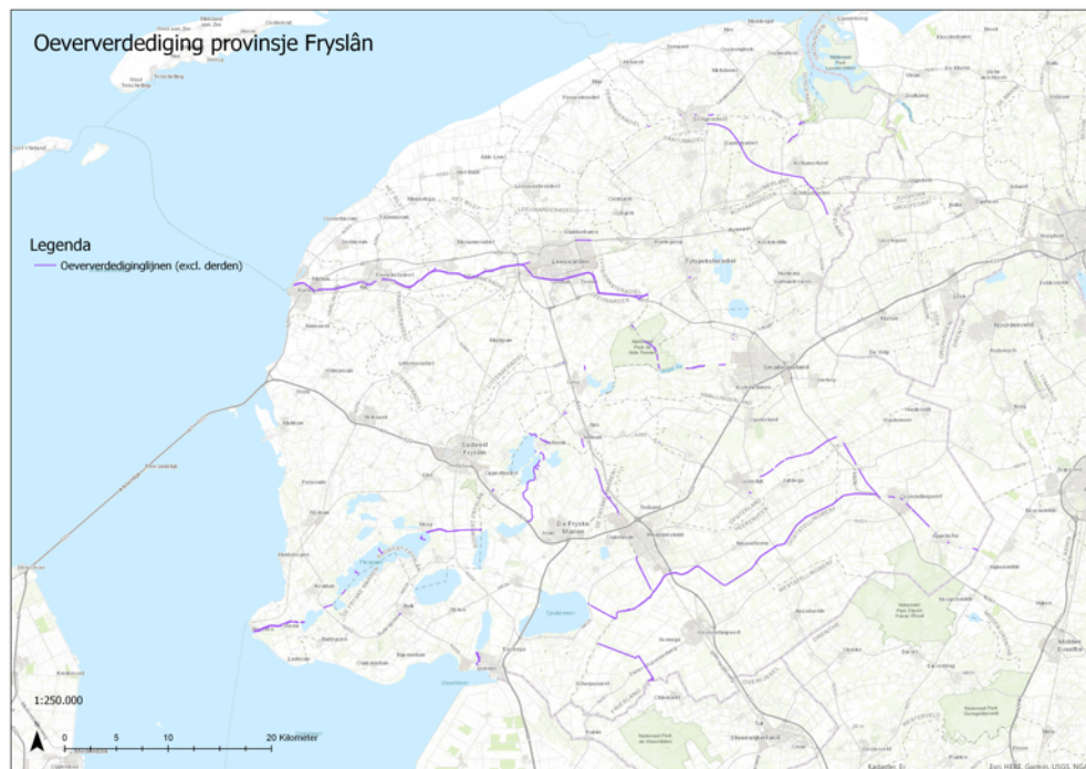
Abbeiding 3 – Oeverconstructies in beheer en onderhoud bij de provincie (ca. 200 km langs vaarwegen)
