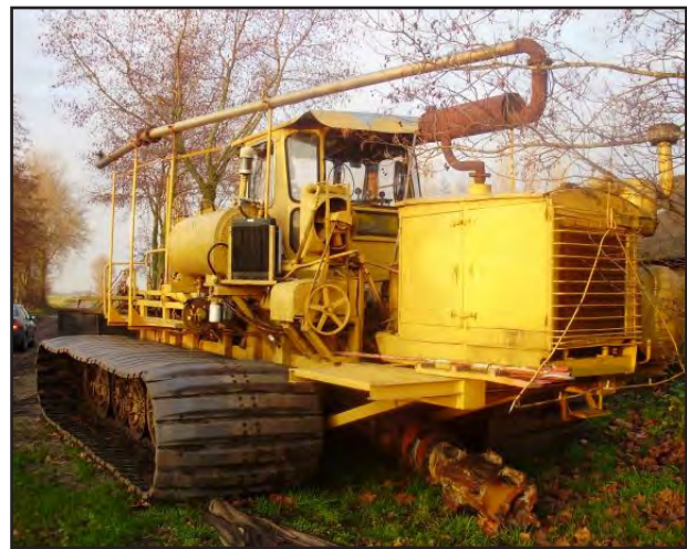
Afb. 41, aan de onderkant van de bezandingsmachine (of grondvijzel/zandhengst) zat een vijzel. Met deze vijzel haalde de machine zand omhoog tot een maximale diepte van drie meter. Het zand werd vervolgens over het maaiveld verspreid om zo een de draagkracht van de zode te verstevigen. ( http://www.tractorfan.nl/picture/301872/ )
